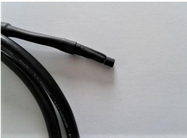
Capteur de température TMP 36
