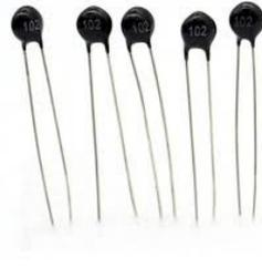
Les thermistances, composées d'un matériau semi-conducteur, combinaison de métaux et de matériaux à base d'oxyde métallique (oxyde de manganèse, cobalt, cuivre et nickel), sont des capteurs de température résistifs, dont la résistance varie de façon importante et non linéaire quand la température change même faiblement.
