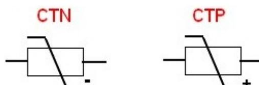
Même si la variation de résistance en fonction de la température d'une thermistance n'est pas linéaire, il est tout à fait possible de l'utiliser pour faire des mesures de température avec une grande précision si la loi de variation est connue, notamment avec une CTN.
