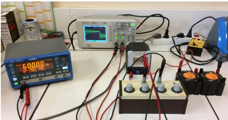
R : Boîtes AOIP (x 1 k $\Omega$  - x 10 k $\Omega$ ), L : bobine 1000 spires (L= 44 mH, r= 9  $\Omega$ ),
