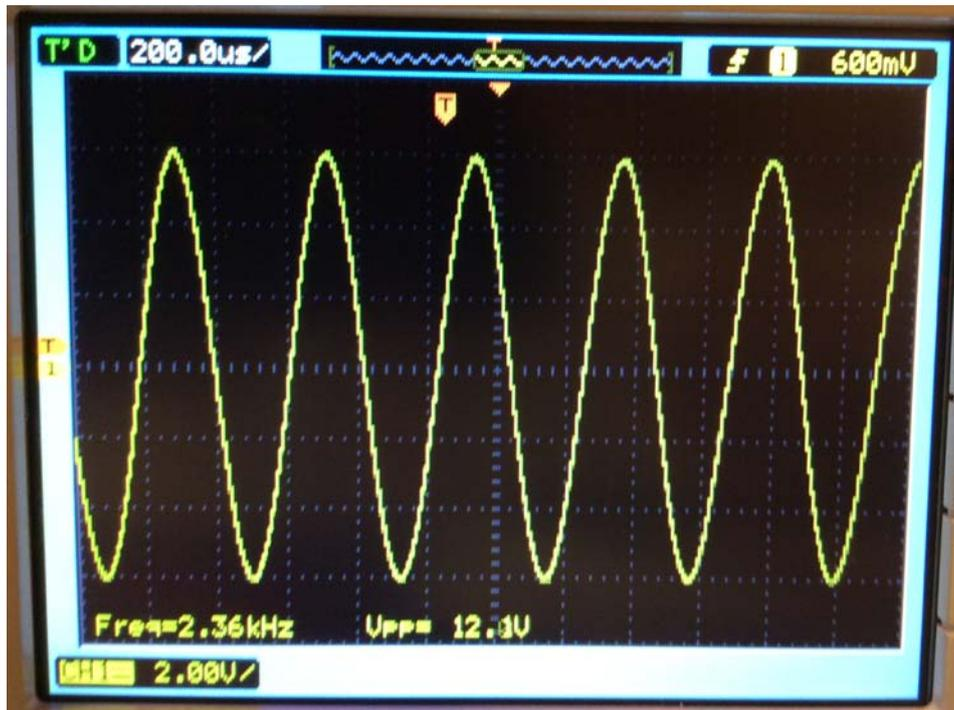
Pour le circuit oscillateur de référence, on utilise un GBF réglé à la même fréquence que le circuit de détection en l'absence de métal :
