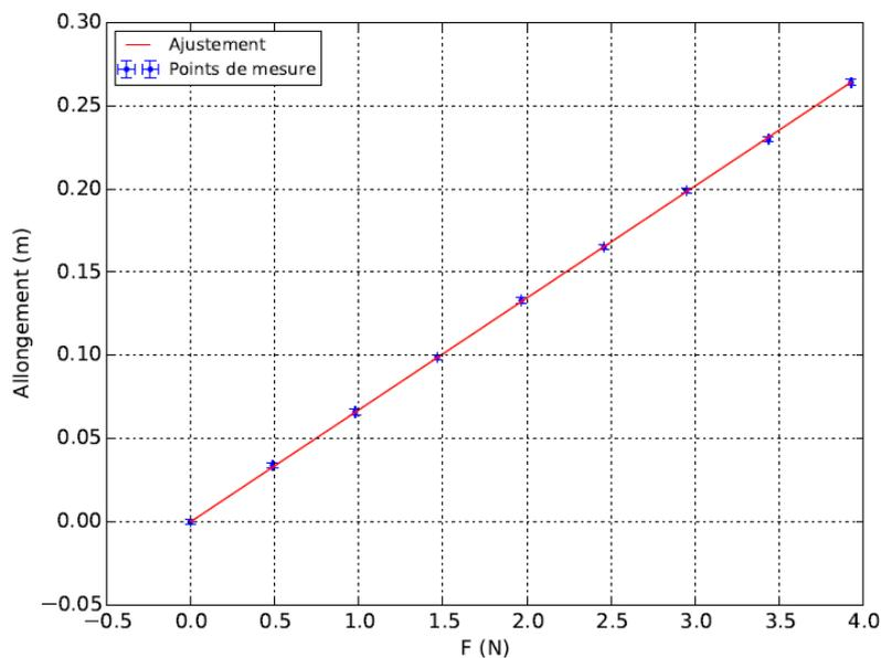
Sur le domaine  $[0, 264 \text{ mm}]$ , l'ajustement par la fonction linéaire  $\Delta l = a \times F$  passe correctement par les points expérimentaux. La loi de Hooke est donc valide.
