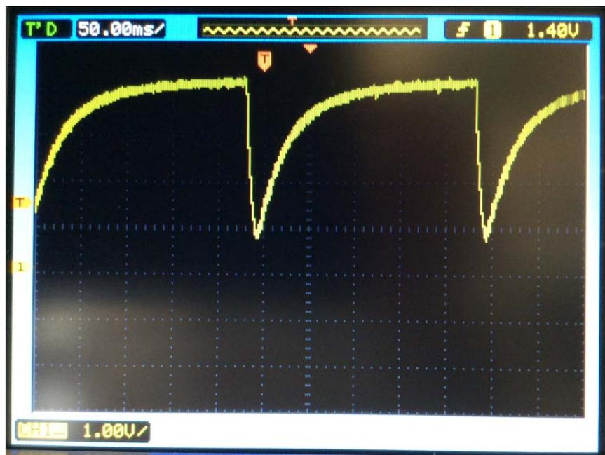
A basse fréquence, l'amplitude du signal  $U_s$  est minimale et à haute fréquence, celle-ci est maximale. On retrouve bien la réponse d'un filtre passe-haut.
