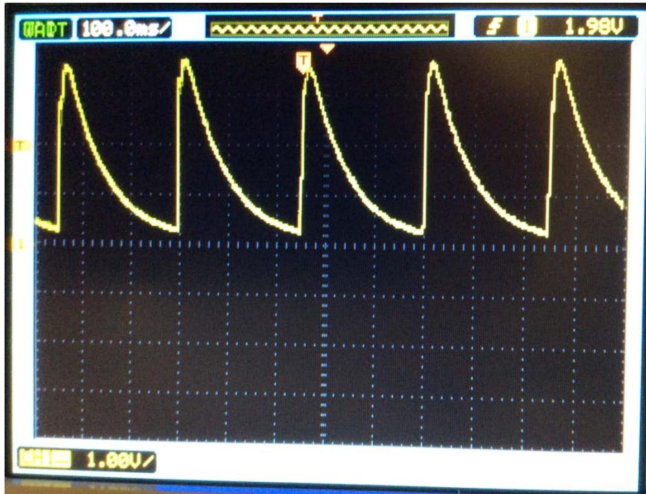
A basse fréquence, l'amplitude du signal  $U_s$  est maximale et à haute fréquence, celle-ci est minimale. On retrouve bien la réponse d'un filtre passe-bas.
