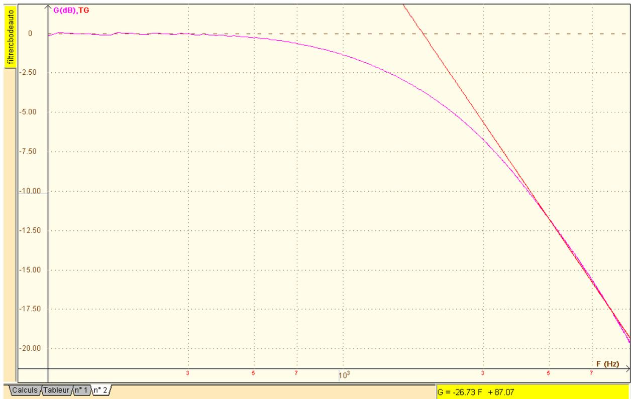
La chute de gain par décade en haute fréquence, mesurée, est cependant un peu plus importante que celle théorique.
