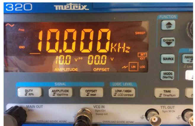
Le balayage de fréquence entre 100 Hz et 10 kHz est linéaire et varie en dents de scie. Le signal wobulé est obtenu à la sortie Main Out du GBF.
