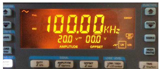
Le balayage de fréquence entre 1000 Hz et 100 kHz est linéaire et varie en dents de scie. Le signal wobulé est obtenu à la sortie Main Out du GBF.
