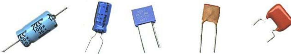
La caractéristique principale d'un condensateur est sa capacité exprimée en **farad**.
