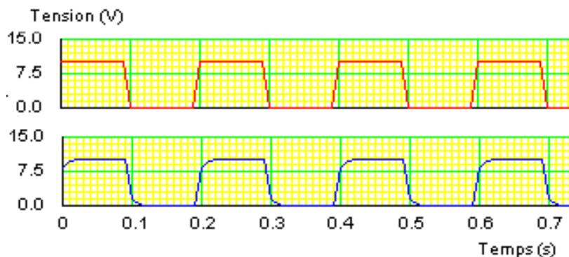
Si la fréquence d'entrée est élevée, le condensateur n'a pas le temps de se charger et de se décharger. La tension en sortie est constante et égale à la valeur moyenne.
