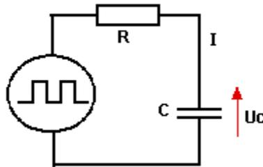
La fréquence du générateur est variable. Nous observons la forme de la tension  $U_C$  en fonction de cette fréquence.
