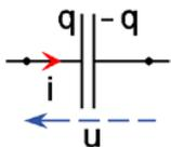
La charge  $q$  est, par convention la charge portée par la plaque par laquelle on entre dans le condensateur.
