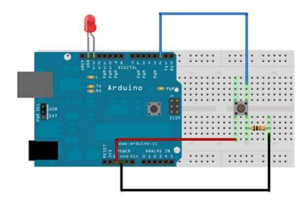
Quand le bouton poussoir est appuyé, le potentiel de sa broche connectée à la broche 2 de l'Arduino passe à 5 V (le circuit est fermé) et quand il est relâché, celui-ci passe à 0 V (le circuit est ouvert).
