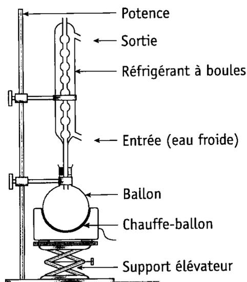
Le milieu réactionnel est chauffé afin d'accélérer la réaction. En effet, en augmentant la température, on augmente la mobilité des espèces chimiques, donc les chances de rencontre entre celles-ci.
