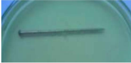
Alors qu'un clou en fer décapé et plongé dans la solution oxydante présente bien deux zones : une coloration bleue et une coloration rose.
