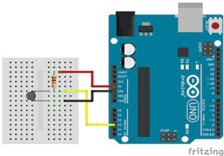
La thermistance est alimentée en 5V depuis l'Arduino. Le point entre les deux résistances est relié à une broche analogique de l'Arduino et on mesure la tension de cette broche par la fonction "**analogRead (broche)**".
