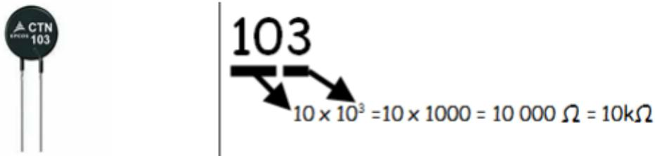
Avec un Arduino, On utilise la thermistance dans un montage (Cf. ci-dessous), avec une résistance fixe de 10 k $\Omega$ , qu'on appelle un diviseur de tension.
