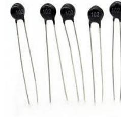
Les thermistances, composées d'un matériau semi-conducteur, combinaison de métaux et de matériaux à base d'oxyde métallique (oxyde de manganèse, cobalt, cuivre et nickel), sont des capteurs de température résistifs, dont la résistance varie de façon importante et non linéaire quand la température change même faiblement.
