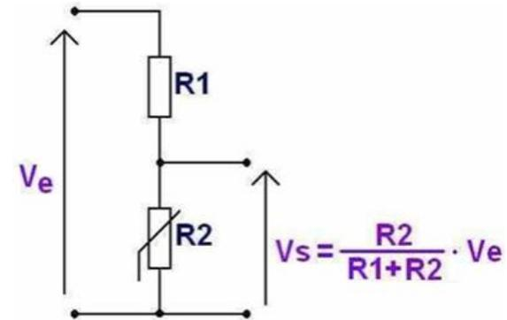
En fonction de la température (T), la valeur de la thermistance R2 varie, ce qui modifie le courant qui circule dans le circuit et donc la tension  $V_s$  aux bornes de R2.
