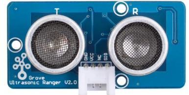
Avec "**pymata-express 1.4**", pour utiliser un capteur ultrasonique, il faut déclarer les broches servant à l'émission et à la réception des ultrasons avec la commande :
