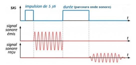
Le principe de calcul de la distance entre ce capteur et un obstacle reste le même.
